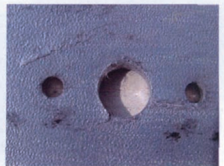
图4 喷丸后表面开裂形貌
